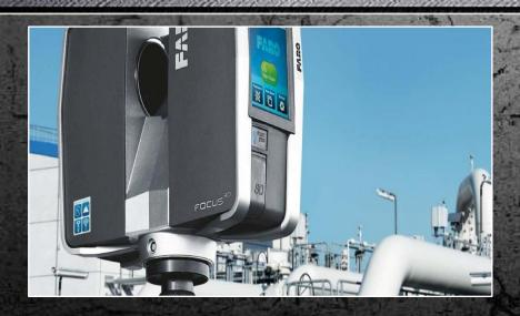
Es un método que nos permite obtener un modelo 2D y 3D de una obra, equipo, componente, u otro, que ha sido modificado en el tiempo, y cuyas modificaciones no se reflejan en el modelo de diseño.
