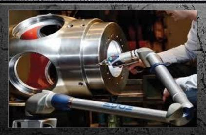
Proceso basado en el análisis y recreación del diseño de un producto, con el uso de piezas físicas, cuyos pasos cruciales son capturar en forma precisa las dimensiones del objeto.
